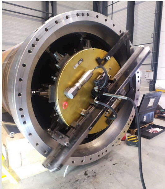
Usinage de bride pour reprise de planéité et d'état de surface / Flange machining for planeness and surface finish recovery
